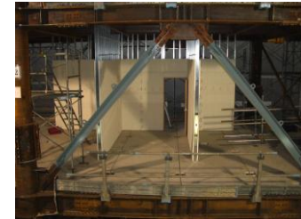
写真-3 在来工法間仕切り壁の加力後の状況 (震度7加力)
