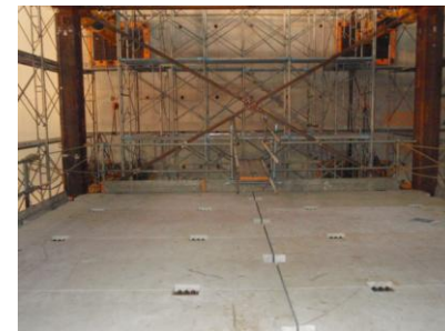
写真-4 床スラブの加力後の状況 (震度7加力)
