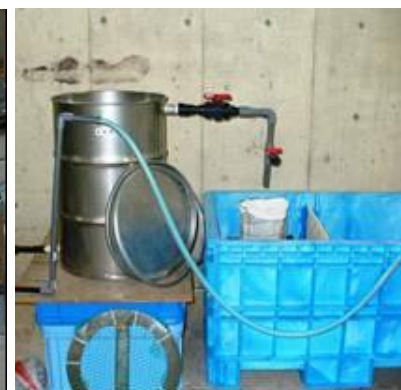
写真3 通水式脱リン装置
