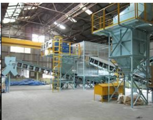
写真2 PAdeCS 破碎・粒調装置
