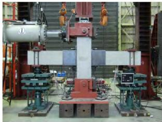
床スラブなしの梁端部補強
