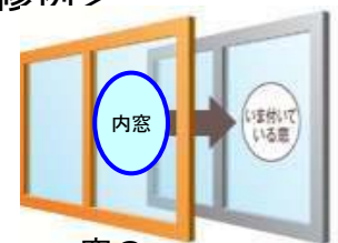
窓の 断熱改修工事
