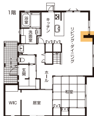
東日本大震災時、家の倒壊を防いだ「耐震壁」。このわずかな部分が、ポイントとなりました。
